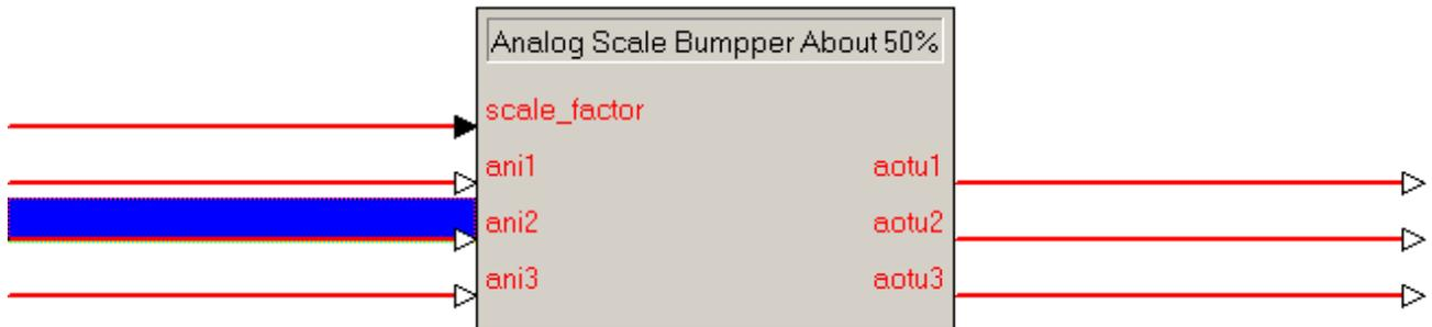
信号/参数: 1 个模拟输入: **<scale\_factor>**
