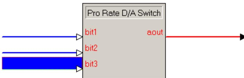
信号/参数: 最高 16 个数字输入: **<bit16 (msb)>**, **<bit15>** 到 **<bit2>**, 和 **<bit1 (lsb)>**
