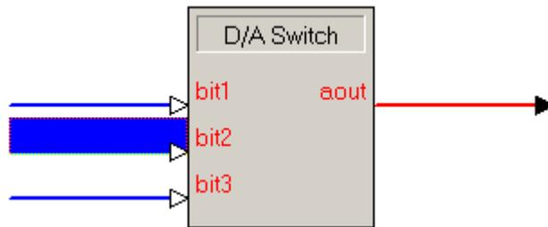
信号/参数: 最高 16 个数字输入: **<bit16 (msb)>**, **<bit15>** 到 **<bit2>**, 和 **<bit1 (lsb)>**
