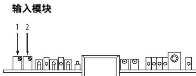
图 19. 输入模块和旁路电平可调电阻（1 和 2）
